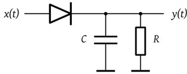
Fig. 6. Diode detector
